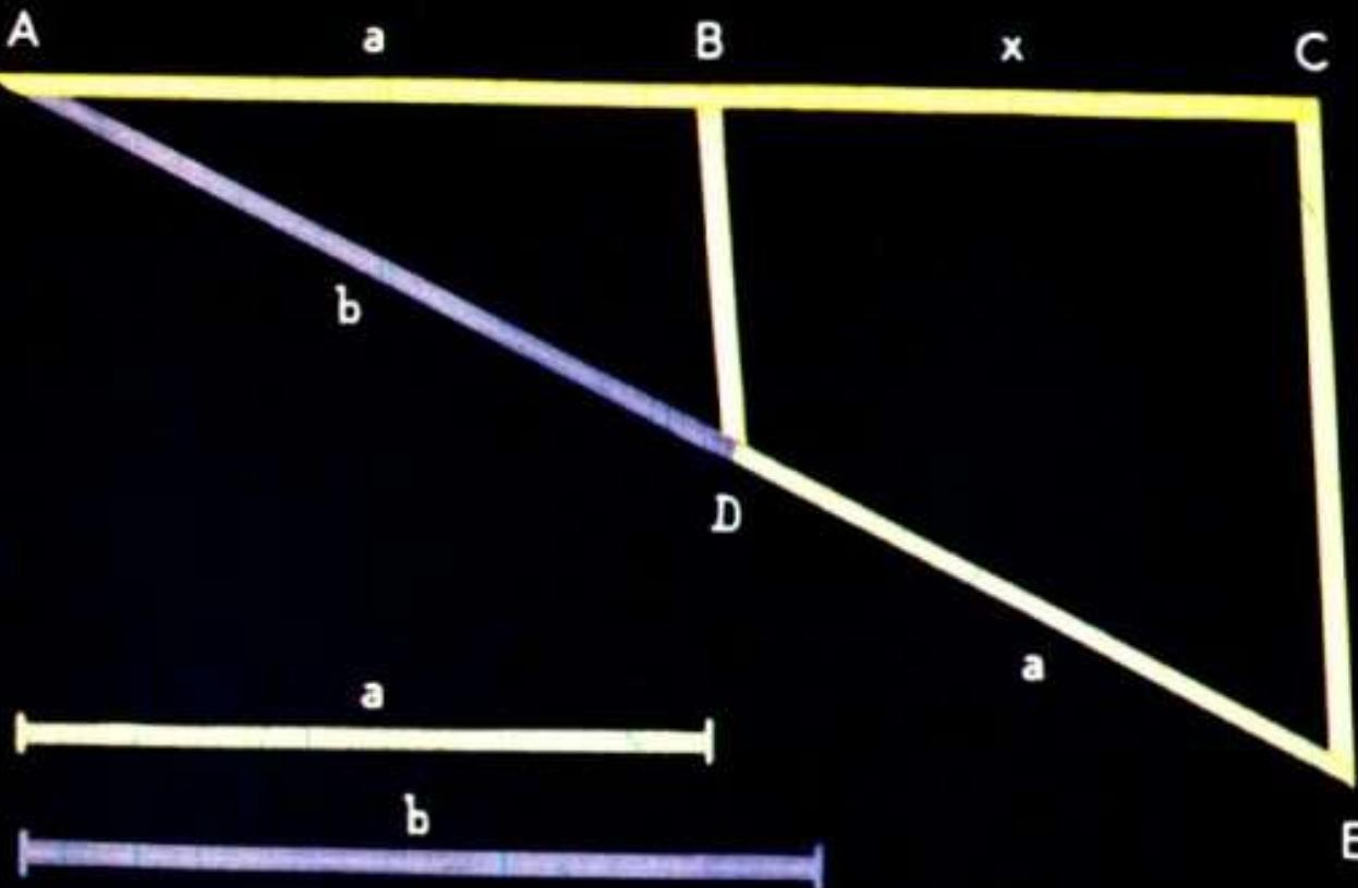
**Задача 4.** Построить отрезок  $x$  так, чтобы  $x = \frac{a^2}{b}$ , где  $a$  и  $b$ —данные отрезки. Решение: запишем данное равенство в виде пропорции  $\frac{x}{a} = \frac{a}{b}$ . Объясните дальнейший ход построения.
