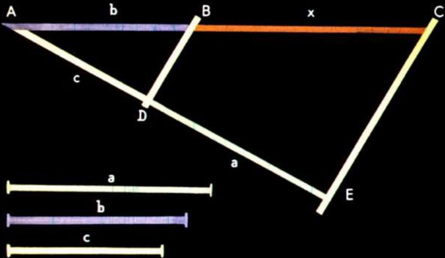
**Задача 3.** Построить отрезок  $x$  так, чтобы  $\frac{x}{a} = \frac{b}{c}$ ,
